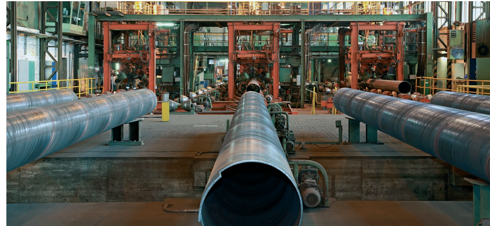
↑ b. UP-Schweißung der Außenlage b. Submerged arc weld seam after external welding b. Soudage SAW face extérieure
