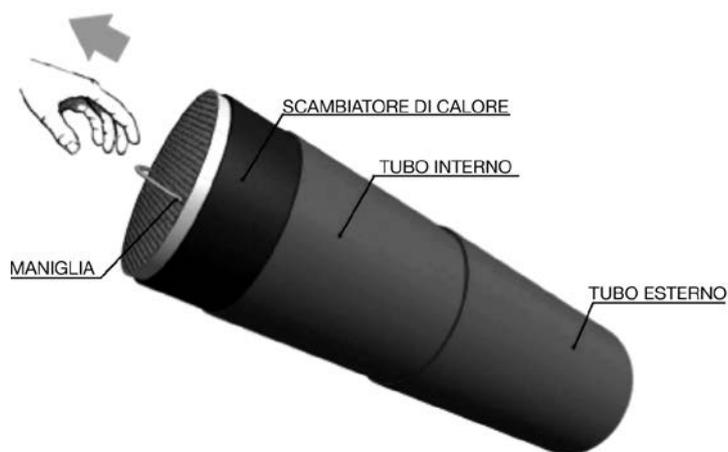
Fig.2 Estrazione scambiatore
