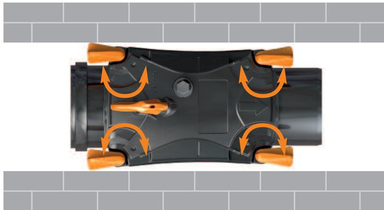
L'apertura del coperchio di Ottima è studiata per essere eseguito senza l'ausilio di attrezzature, cacciaviti o chiavi, direttamente azionando le leve di apertura e chiusura. Nella foto si vede che l'apertura è possibile anche a ridosso di pareti o bordi di pozzetto. Queste sono realizzate in polimero caricato in Nylon altamente stabilizzato per una resistenza elevata nel tempo, tali parti sono comunque sostituibili.
