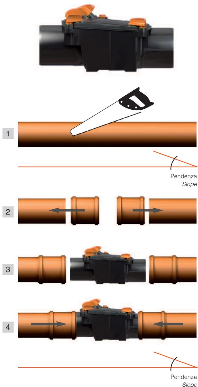
Grazie al basso Off-Set prima e dopo l'installazione l'angolo di inclinazione della tubazione non cambia (fig. 1 e 4).
