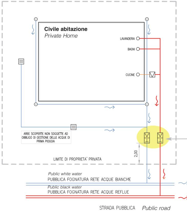
Sono riportati due esempi di collocazione della valvola antiriflusso, secondo la normativa vigente in Italia. Nel primo caso abbiamo una civile abitazione nel secondo un sito produttivo. La valvola antiriflusso deve essere installata sia sul circuito delle acque bianche che su quello delle nere.
